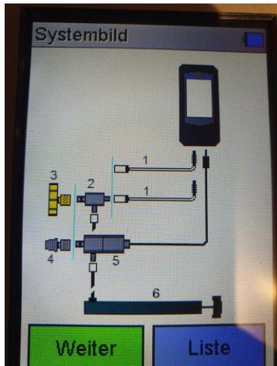
3. Danach steckte ich die Pumpe und den Schlauch zusammen. Jetzt ist alles Betriebsbereit, ich wählte im Menü Wasserleitung, anschliessend musste ich das Volumen der Leitung angeben in meinem Fall weniger als 1l. Mit der Handpumpe pumpte ich bis 151 mbar, dann startete ich den Test.
