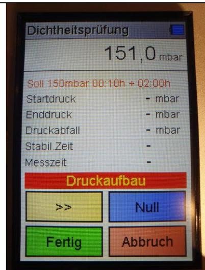
4. Anhand des Diagrammes kann man die Druckprobe genauestens verfolgen. Ich wartete 25 Minuten lang. Der Druckabfall war niedrig somit ist die Druckprüfung positiv ausgefallen.
